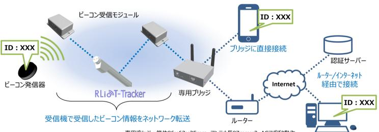
専用ブリッジ: 筐体86×63×25mm、アンテナ長87mm×2、ACアダプタ動作
